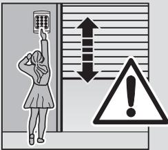
Iebūvētos vadības taustiņus un līdzīgas ierīces iemontējiet pie vārtiem redzamā vietā, bet drošā attālumā no kustīgajām detaļām. Piestipriniet bērniem neaizsniedzamā vietā vismaz 1,5 metru augstumā!
