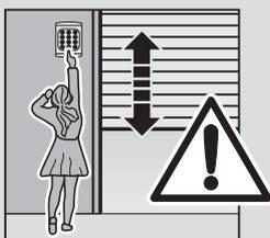
Pevne namontované jednotky ovládania (ako napr. tlačidlá), treba namontovať v dohľade brány, ale vzdialené od pohyblivých častí. Treba ich umiestniť bezpodmienečne mimo dosah detí, vo výške minimálne 1,5 metra!
