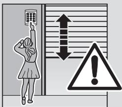
Неподвижно установленные приборы управления (кнопочные выключатели и т.п.), необходимо смонтировать на расстоянии видимости от ворот, однако в стороне от движущихся частей. Их нужно обязательно устанавливать на высоте, не доступной для детей (минимум 1,5 метра)!
